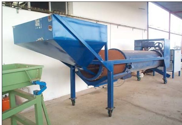
FOTO N° 12: Máquina separadora de pistachos abiertos
